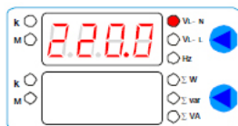
Рис. 19 – Пример работы прибора. Режим отображения среднего фазного напряжения
